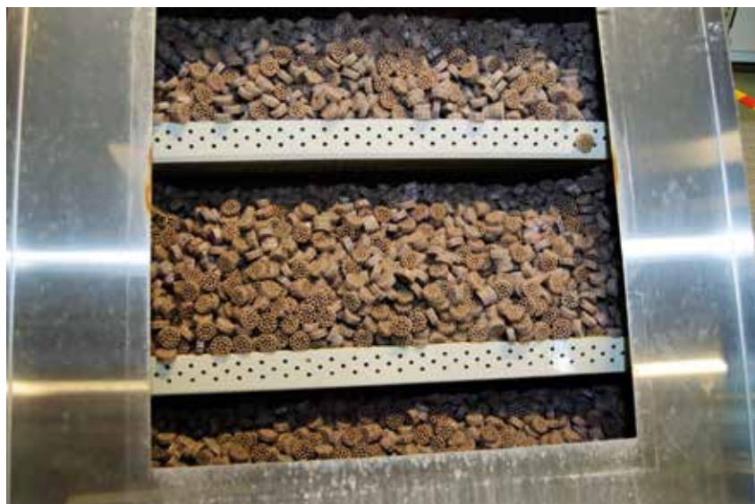
GJØDSLINGSPRODUKT: Hias tar ut stoffet Struvitt, som inneholder ca. 12 prosent rent fosfor og som kan benyttes i et gjødselprodukt. Foto: Hias
