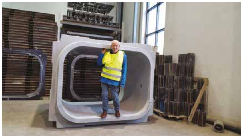
Odd Arne Vagle, Sandnes kommune, i det aller første norsk-produserte firkantrøret, Box Culvert fra Skjæveland. Foto: Inger Anita Merkesdal
