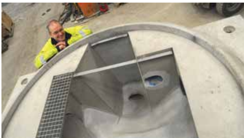
Tore William Larsen, driftsleder ved Kommunalteknikk og Utemiljø – Vann og avløp i Lillehammer, ved en spesialkum BetoNor Vingrom har produsert på oppdrag av kommunen. Kummen har ett hovedløp på DN 800, to sideutløp på henholdsvis DN 500 og DN 200, og blir som et kryss i overvannsnett. En lokal smed har laget den løftbare risten.
