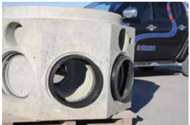
Renneløpskumen har løp på DN 300. I det midterste løpet er det montert overgang til DV-X-stream rør. Til høyre Muffens ig - pvc overgang for tilknytning av glattvegget pvc rør DN 300.
