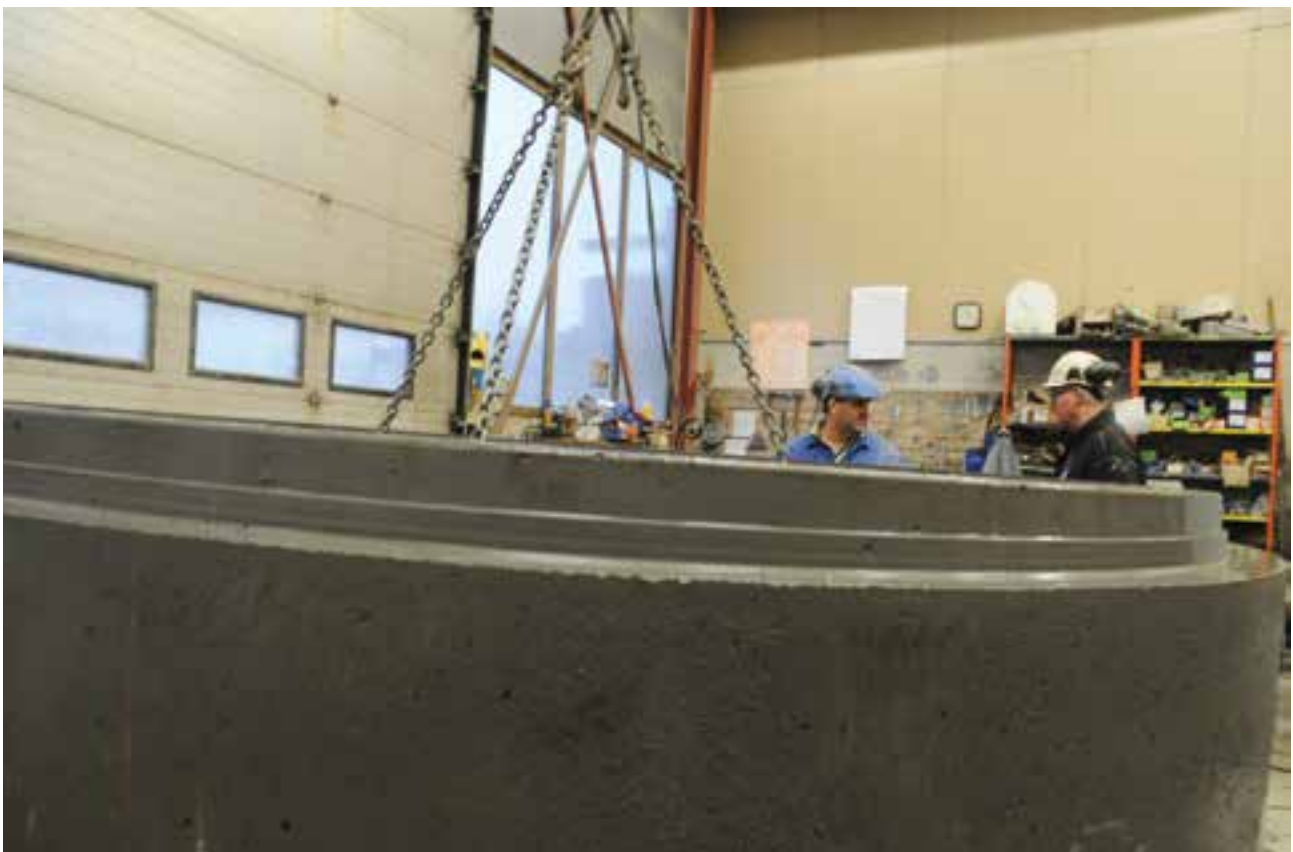
Nobi har bokstavelig talt fått en storleveranse på vannkummer. Bedriften leverer 15 vannkummer med innvendig diameter opp til DN 3000 til veiprojektet til Vassbakk & Stol. Dette er en av kummene.
