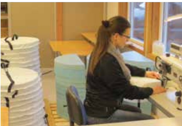
Produksjonshallen har moderne utstyr. Her festes løftereimen til Isolokket.
