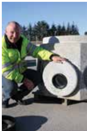
I ig-proppen er det kjerneboret et hull på DN 186. I hullet er det satt en F-910 pakning for kobling av DN 160. I denne dimensjonen kan det bores hull opp til DN 200. Større dimensjon renneløpskum kan ha tilsvarende større hull.
