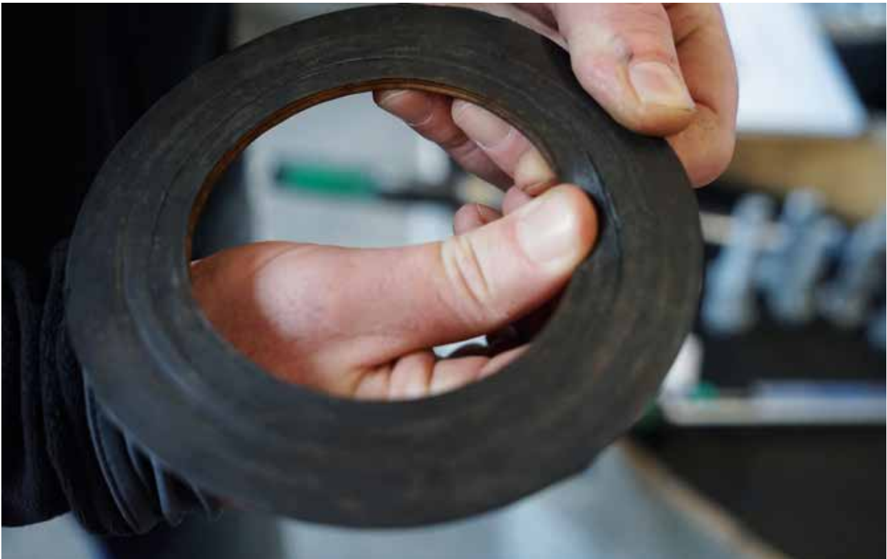
FEILMONTERING: – Se på denne pakningen. Den har blitt montert med for høyt moment på boltene og den ser ikke bra ut, sier han og viser fram en tydelig mørken pakning.
