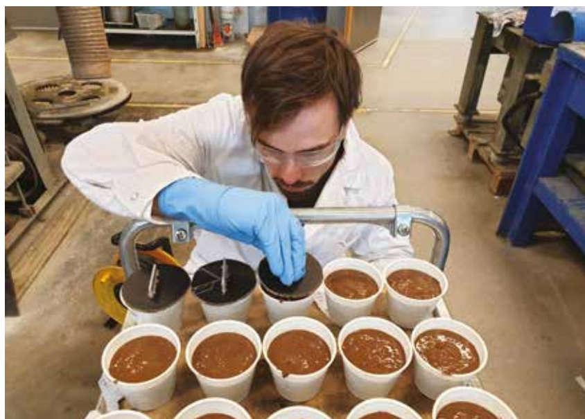
STOR INTERESSE: Det er stor interesse for dette prosjektet blant studenter. Her lages prøver for heft mellom aluminium og mørtel. Foto: SINTEF
