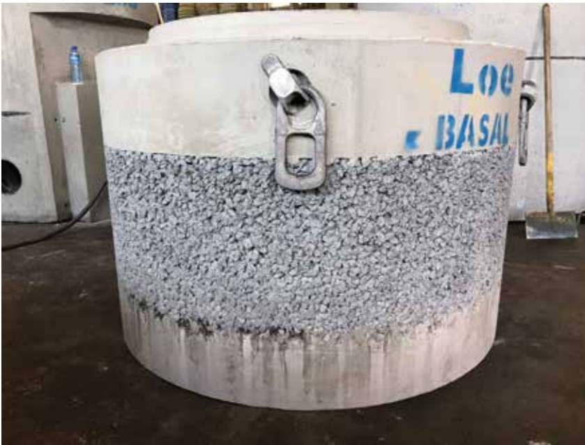
PERMAKUM: Det permeable laget er plassert et stykke over kumbunnen slik at sand og sedimenter gis mulighet til å holdes tilbake før overvannet sendes ut til infiltrasjon.
