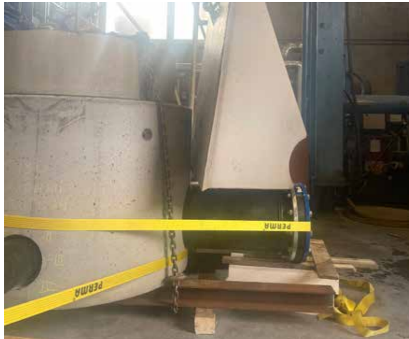
TESTOPPSETT 2: Samme testoppsett som 1, men her er det største PE-røret påført en punktlast på 720 kg. Betongloddet er plassert på en trekloss 25 cm fra kumvegg. Ingen lekkasje ble registrert.
