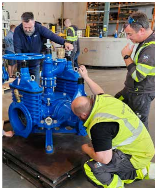
RIPER I LAKKEN: Ronny Gilje fra Østraadt Rør, Willy Vanvik Brattelid og Ståle Ingvarstsen fra VA-avdelingen i Stavanger kommune letter etter korrosjonskader som oppstår der lakken er skadet.
