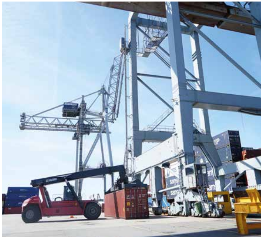
KRAV TIL ESKTRÅ DIMENSJONERING: Havneanlegg har trafikk som gir en vesentlig større last enn hva standard betongrør er dimensjonert for.
