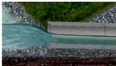
AVFASET KANT/MUFFENDE RØR Nødvendig rørdiameter: DN 800 Vannstand v. innløp**: 0,74 m Kritisk helning (promille)*: 6 ‰
