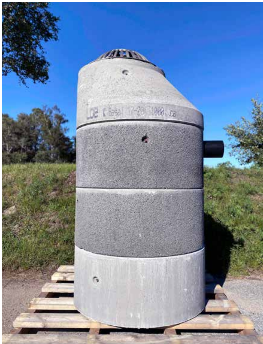
PERMAKUM: Sandfang med permeable kumringer. Vannet infiltreres gjennom kumveggen i stedet for gjennom en plastdykker i bunnen. (Foto: Loe Rørprodukter AS)
