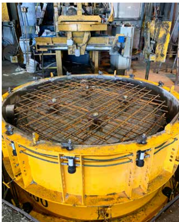
VIKTIG: De viktigste kravene i denne sertifiseringen er kravet til typeprøving, armeringen og korrekt forankring i konsoll og kumbunn.
