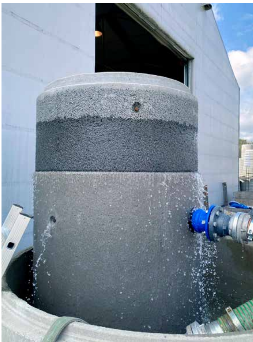
LEKKER: Permakum holder slam og forurensning igjen inni, og slipper ut vannet i grunnen.
