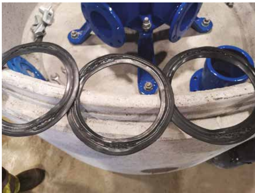
Dette er hva som kan skje hvis ikke alt er riktig i en flenseforbindelse. I dette tilfellet var det feil på vulkingen av pakningene. Vi vet ikke hvor mange av disse som er montert på anlegg.
