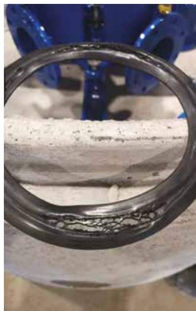
Dette er hva som kan skje hvis ikke alt er riktig i en flenseforbindelse. I dette tilfellet var det feil på vulkingen av pakningene. Vi vet ikke hvor mange av disse som er montert på anlegg.
